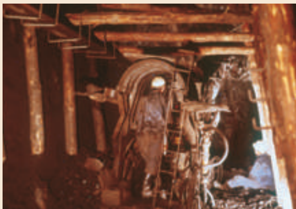
▲ Des efforts de productivité sont réalisés. Fin 1963, 4 machines d'abattages baptisées «Rosalie» sont mises en service dans les dressants.
